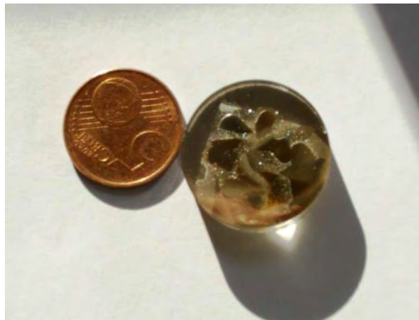
Abbildung 4: Elektronenstrahlmikrosondenschliff mit Silexprobenmaterial
