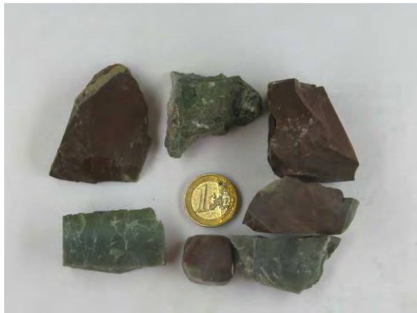
Abbildung 15: Makroskopische Aufnahme der Probe GP04, Rofangebirge. Das Farbspektrum bewegt sich zwischen grünlich-grün bis hin zu einem matten ziegelrot. Zum Teil ist an den Fragmenten noch ein Cortex zu erkennen.
