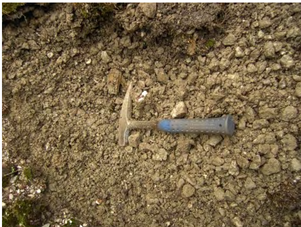
Abb.: 56: Haldenmaterial aus einer der Abraumhalden am Lobinger. Die Bruchstücke aus den Halden sind hier als Mittel- bis Grobkiese zu beschreiben. Selten sind auch größere Blöcke anzutreffen.
