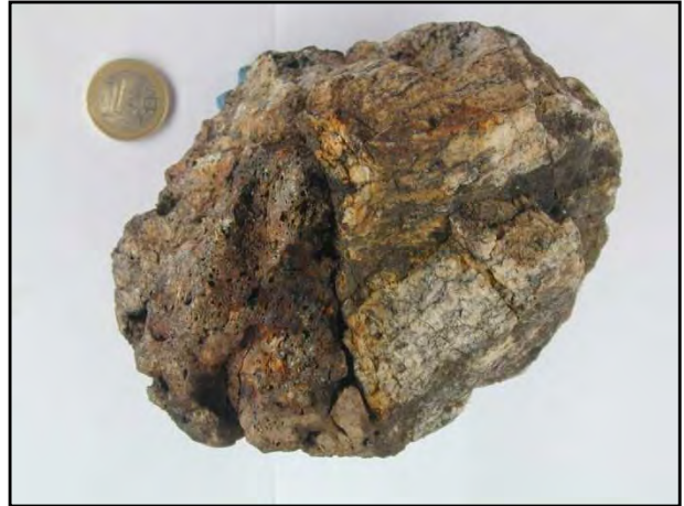
Abb.: 239: Ofenstein aus Orthogneis (re.) an dem die Schlacke angeschweißt worden ist. Der Orthogneis ist gänzlich von Rissen durchzogen.
