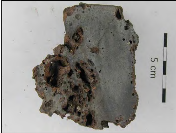
Abb.: 236: Kupferschlacke mit Blasenstruktur. Innerhalb der Blasen sind noch Holzkohlereste zu erkennen.
