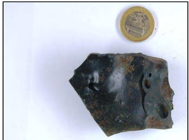
Abb.: 235: Die Oberfläche der Plattenschlacke ist sehr glatt und weist eine geringe Porosität auf.
