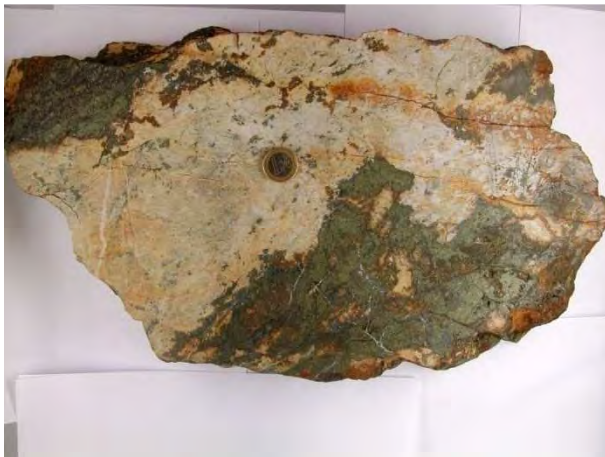
Abb.: 64: Aufnahme eines Anschnittes einer Probe aus dem Fritzentobel. Hellbraun bis leicht orange erscheint die karbonatische Gangart. In dunkelgelbgrünlich erscheinen die feinkörnigen Pyritaggregate. Maßstab ist die 1€ Münze in der Bildmitte.
