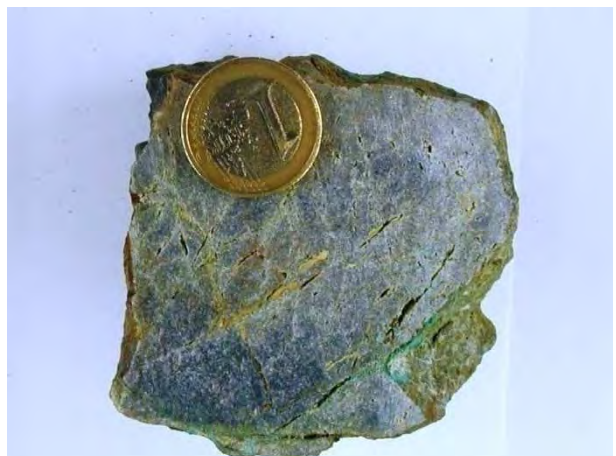
Abb.: 61: Anschnitt des beprobten Haldenmaterials. Entlang der Risse dringen Alterationsprodukte von sulfidischen Kupfermineralien ein und rufen eine intensive Grünfärbung hervor. Z.T. sind auch limonitisierten Bereiche erkennbar.
