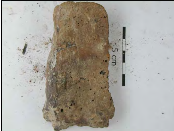
Abb.: 240: Mit Schlacke überzogener Orthogneis, der am unteren Ende deutliche Blasenbildungen aufweist. Die auf der linken Seite abgebildete Nahaufnahme zeigt deutlich die Auswirkungen der thermischen Beanspruchung.
