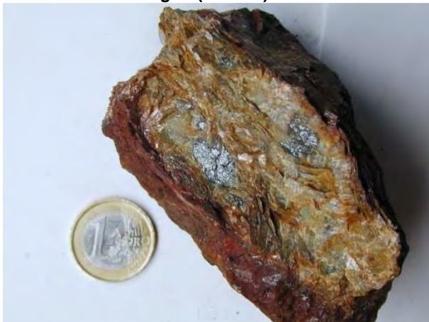
Abb.: 70: Rötlicher Verwitterungssaum der Eisenkarbonate. Im frischen Zustand weisen die Fe-Karbonate eine deutlich hellbraune Farbe sowie die typischen Spaltbarkeiten auf. Fahlerz weist eine grünlische Farbe mit hohem metallischem Glanz auf.
