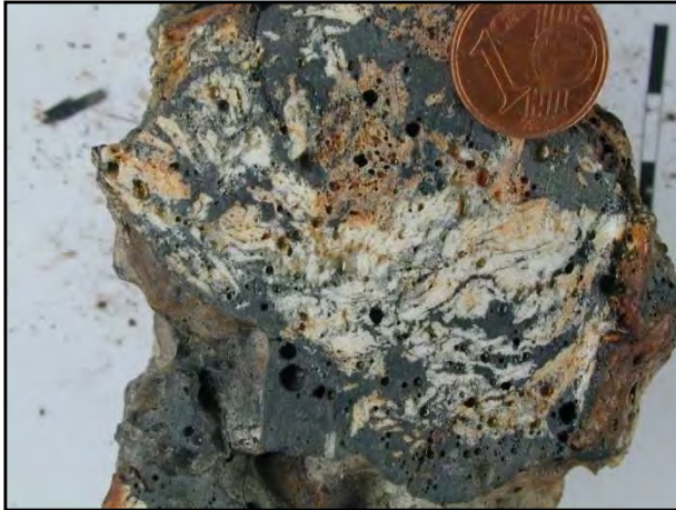
Abb.: 238: Dieser Ofenstein weist ein völlig durch Pyrometamorphose zerstörtes Gefüge auf. Reliktische Minerale sind außer Quarz und Feldspäten keine mehr zu erkennen.
