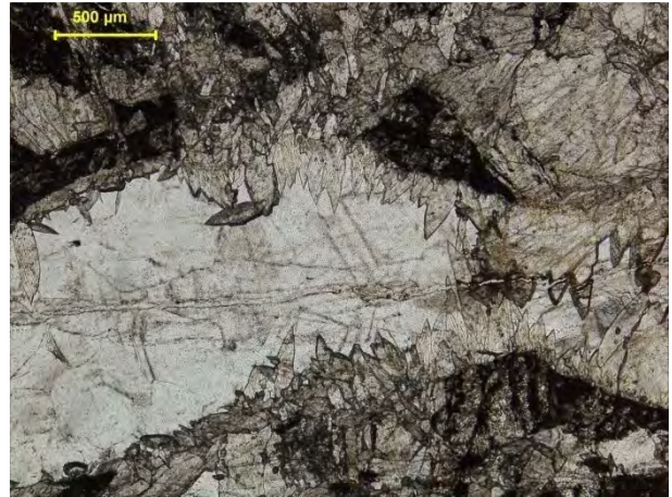
Abb.: 109: Durchlichtaufnahme (pN) der Probe HBA. Die Karbonate bauen den äußeren Bereich auf und im inneren Bereich treten hypidiomorphe Quarze auf.
