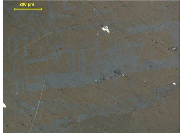
Abb.: 75: Auflichtaufnahme bei leicht xN. Deutlich zu erkennen sind hier die "oleanderblattförmigen" Zwillingslamellen im Chalkopyrit. Probe HP2.
