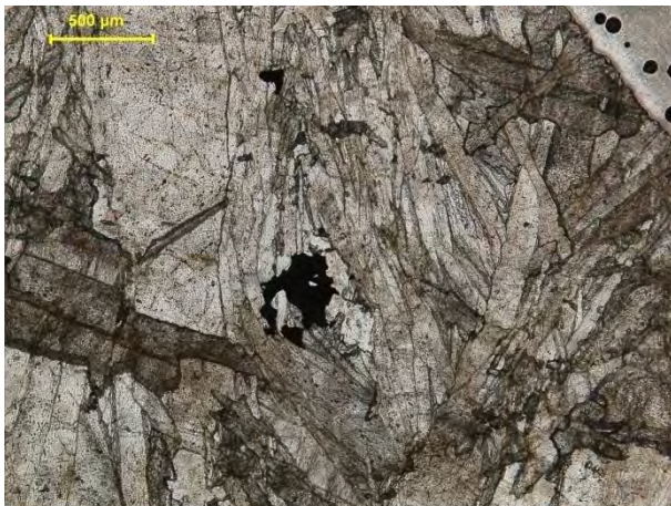
Abb.: 106: Durchlichtaufnahme (pN) der Probe Kr1. Die Barytkristalle weisen eine längsprismatische, tafelige Form auf.
