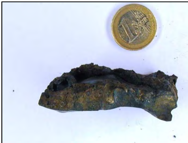
Abb.: 234: Seitenansicht einer Plattenschlacke aus dem Schmelzplatz. Dieser Schlackentyp weist im Querschnitt keinerlei größere Blasen auf.
