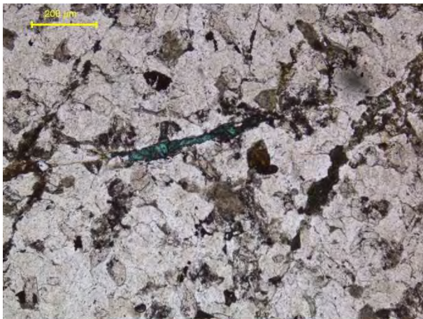
Abb.: 130: Durchlichtaufnahme (pN) der Probe Re2. Die Feldspäte zeigen deutliche Alterationserscheinungen. Entlang von Rissen bildet sich Tyrolit als Verwitterungsprodukt von Kupfersulfiden.
