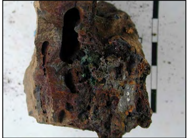
Abb.: 237: Makroaufnahme einer Kupferschlacke. Die Grünfärbung, die durch die Verwitterung von Kupfer hervorgerufen wird, ist hier deutlich zu erkennen.
