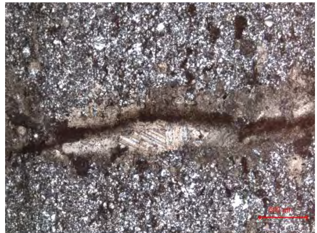
Abbildung 22: Durchlichtaufnahme bei gekreuzten Nicols der Probe GP07. Gut zu erkennen sind die mikrokristallinen Quarze, die wiederum die Grundmasse bilden. Entlang eines Risse drang Kalzit postsedimentär ein.
