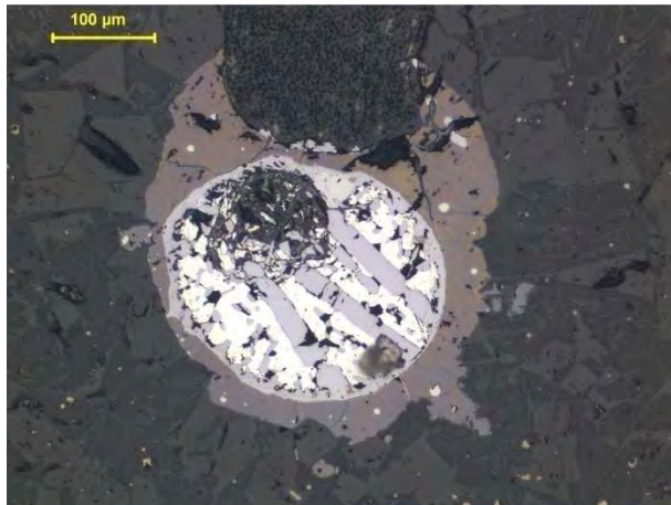
Abb.: 246: Auflichtaufnahme eines Schmelztropfens bei pN. Für die genauere chemische Zusammensetzung wurde von diesem Schmelztropfen ein Elementverteilungsbild mittels der EMPA angefertigt. Probe SL5.
